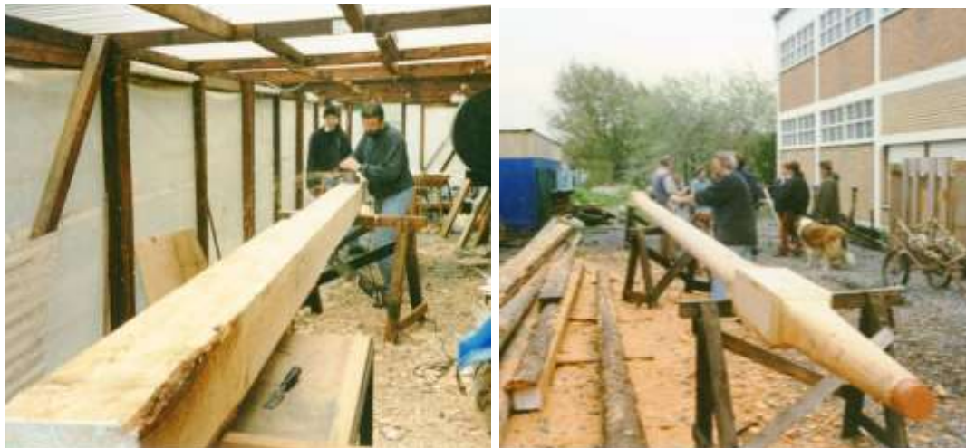
De oorspronkelijke mast onder constructie in 1996, een Larix van 14 m
